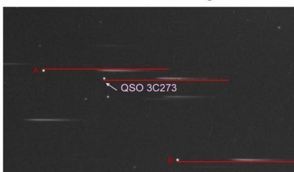
Die Empfindlichkeit des Sensors der Kamera liegt im Spektralbereich von 400nm (~30%) über 500nm (~55%) bis 700nm (~30%). Der Abstand des Transmissionsgitters von 12mm vor dem Sensor erzeugt ein Spektrum der 1. Ordnung von ~130 Pixel Länge (hier als Kurve des IRIS-Plots dargestellt) in der Distanz von ~130 pix von der 0. Ordnung (dem Stern, bzw. Quasar).
